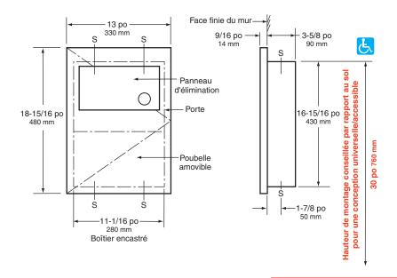
Ouverture brute du mur 11-1/2 po (290 mm) de large 17-1/4 po (440 mm) de haut 3-3/4 po (95 mm) minimum Profondeur d'encastrement
