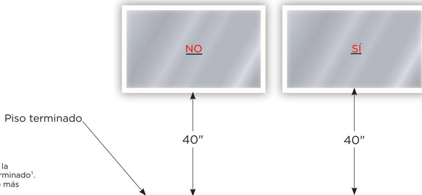
La ADA requiere que los espejos se monten con el borde inferior de la superficie reflectiva a menos de 40 pulg. (1015 mm) sobre el piso terminado<sup>1</sup>. Para los espejos iluminados, esto significa que la medida es al borde más interno de la parte iluminada.
