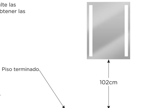
La ADA requiere que los espejos se monten con el borde inferior de la superficie reflectiva a menos de 40 pulg. (1015 mm) sobre el piso terminado<sup>1</sup>. Para los espejos iluminados, esto significa que la medida es al borde más interno de la parte iluminada.
