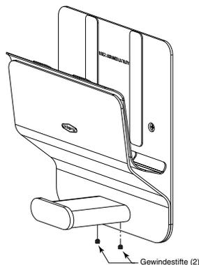
1. Die Gewindestifte unten am Haken mit einem Innensechskantschraubendreher (nicht im Lieferumfang enthalten) entfernen.
