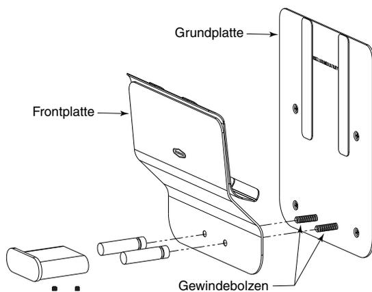
4. Die Frontplatte von der Rückplatte entfernen, indem die Frontplatte von den Gewindebolzen abgezogen wird.
