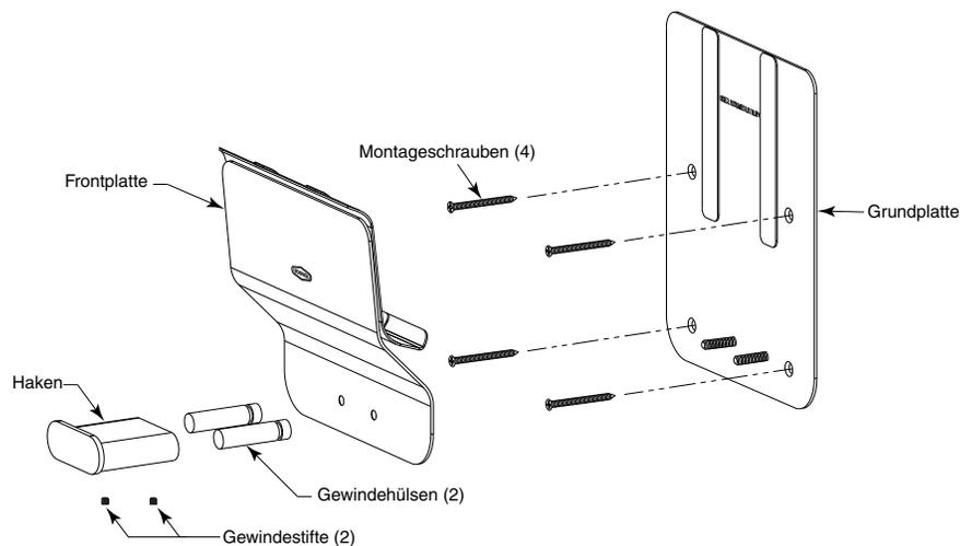
5. Die Einheit an den Schraubenlochpositionen mit den Montage-Blechschraben Nr. 8 (nicht im Lieferumfang enthalten) befestigen. Die Schraubenlänge ist abhängig von der Wandtiefe (Kabinenwand zum Mauerwerk).
