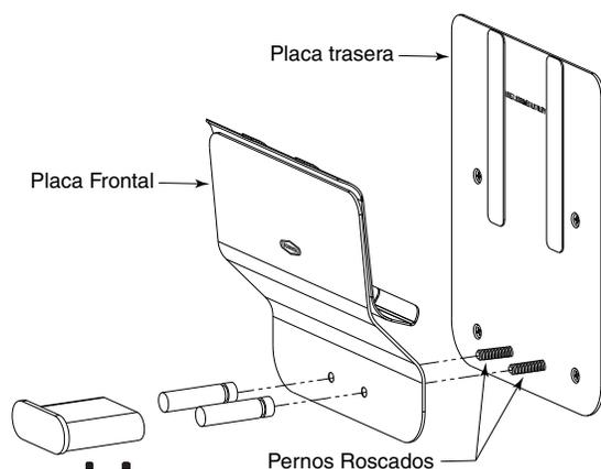
4. Separe la placa frontal de la placa posterior tirando de la placa y separando de los pernos roscados.
