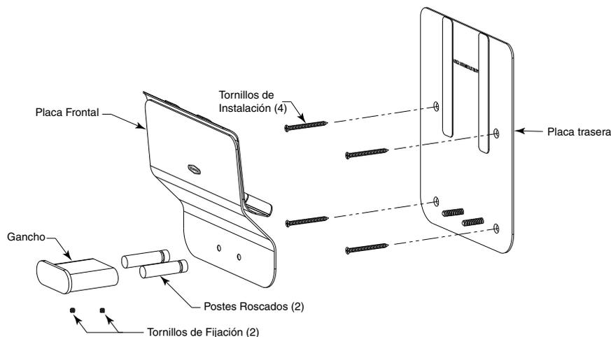
5. Coloque la unidad contra la pared, alineando el equipo con los orificios de los tornillos y asegurando con los tornillos de chapa número 8 (no incluidos); la longitud del tornillo depende de la profundidad de la pared (partición a mampostería).
