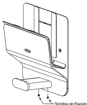
1. Retire los tornillos de instalación ubicados en la parte inferior del ensamblaje del gancho utilizando la llave Allen (no incluida).
