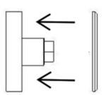
5. Die Trockenbau-Hülsen mit der flachen Seite auf beiden Befestigungsrosetten (Abdeckrosetten) anbringen.
