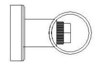
Beide Seiten mit dem Ringschlüssel des 13-mm-Schlüssels festziehen. Dabei darauf achten, das Rohr nicht mit dem Ringschlüssel zu beschädigen.
