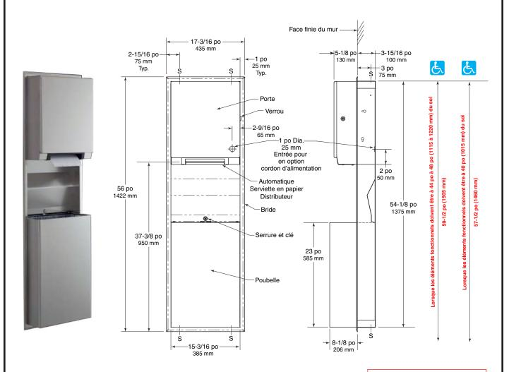
Ouverture brute du mur 16 po (405 mm) de large 54-5/8 po (1390 mm) de haut 4 po (102 mm) minimum Profondeur d'encastrement
