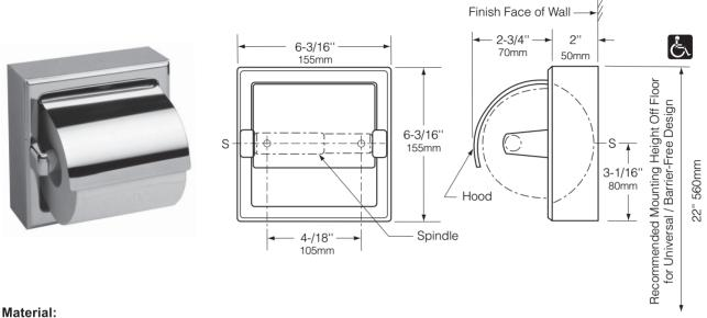
Schale und Montagerahmen: Edelstahl CrNi 18/10 (1.4301), 0,8 mm. Gezogene, nahtlose Konstruktion aus einem Stück. mit zwei versenkten Befestigungslöchern.
