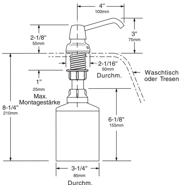
**MATERIAL:****Kolben, Auslauf und Deckel** – Edelstahl CrNi 18/10 (1.4301), hochglanzpoliert.**Deckeldistanzstück** – Stabiles, stoßfestes Polyester.**Abdeckungsflansch** – Verchromter, stoßfester ABS-Kunststoff, hochglanzpoliert. Verdeckter Sperrmechanismus.**Spenderkörper und Schaft** – Stoßfester Kunststoff.**Ventil** – ABS-Zylinder. Feder aus Edelstahl. Dichtung und Schnabelventile.**Behälter** – Durchsichtiges, bruchsicheres Polyethylen. Füllmenge: 0,6 l.**BEDIENUNG:**
